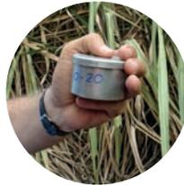
Cada caja se pesa en una balanza de precisión y se lleva a un horno a 105 °C durante 24 horas para obtener así el contenido gravimétrico de humedad a capacidad de campo.
