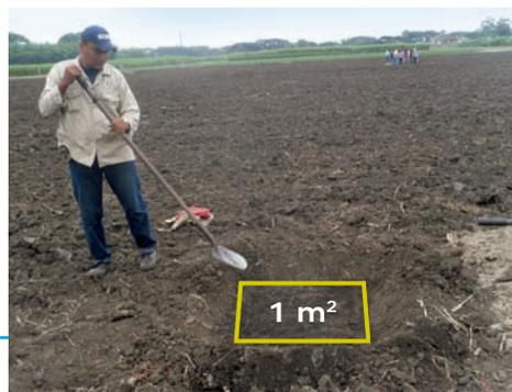
Sobre el perímetro del cuadrado demarcado se levanta un dique de 15-20 cm de altura, recogiendo tierra de afuera, para formar una especie de poceta o piscina. Este dique se compacta con la pala para evitar que ceda al llenarlo de agua.
