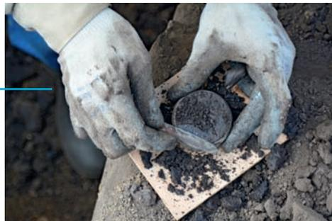
El volumen ( $V$ , en  $\text{cm}^3$ ) de los cilindros o anillos se puede determinar midiendo su diámetro interno ( $D$ , en  $\text{cm}$ ) y su altura ( $h$ , en  $\text{cm}$ ), utilizando la siguiente fórmula:
