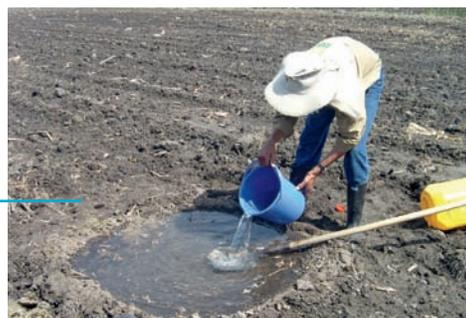
Si el suelo está muy seco se vierten en la poceta, lentamente, entre 150 - 200 litros de agua para que el perfil del suelo se sature hasta una profundidad de un metro como mínimo. En caso de que el suelo esté húmedo se requiere menos cantidad de agua para saturarlo.
