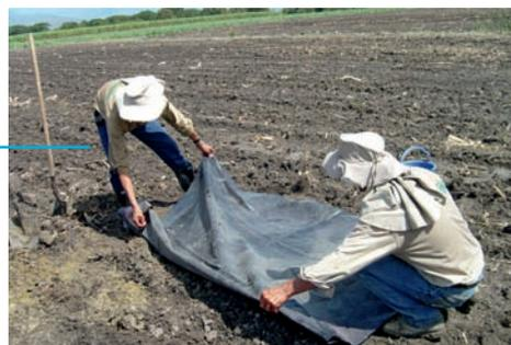
Una vez saturado el suelo de la poceta se cubre con un plástico oscuro o con empaques de plástico abiertos, para evitar la evaporación, y sobre esta cubierta se pone un poco de suelo suelto para evitar que el viento la mueva.
