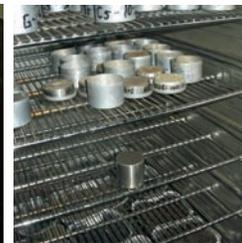
El porcentaje de humedad (CH) de la muestra de suelo es la relación entre el peso del agua perdida por la muestra ( $P_w$ ) y el peso de la muestra seca ( $P_{ss}$ ), multiplicado por 100, así:
