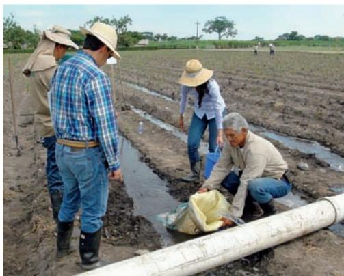
Si el caudal que sale por la compuerta es alto (más de 3 l/s), para el aforo se puede utilizar una bolsa plástica, por ejemplo un empaque de urea, y un balde con graduación en litros.
