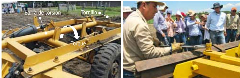
Al ajustar el tornillo de la barra estabilizadora se crea un torque y el marco tiende a rotar alrededor de la barra; como reacción se levantan el lado delantero derecho y el lado posterior izquierdo de la rastra. Al soltar el tornillo disminuye el torque y bajan los puntos mencionados.
