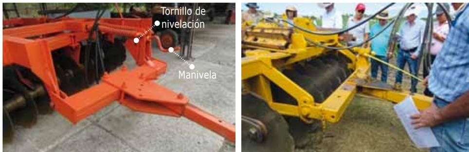
**Un giro de manivela en sentido contrario a las manecillas del reloj incrementa la carga sobre el cuerpo delantero, con lo cual:**
