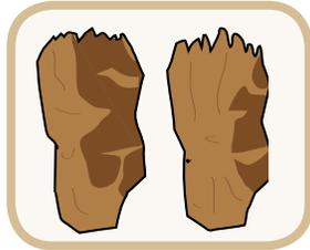
**Prismática:** partículas de suelo agrupadas en bloques alargados. El agua circula con mayor dificultad y el drenaje es deficiente. Esta estructura es común en suelos arcillosos o de textura fina.
