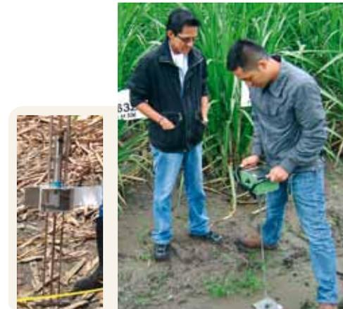
Penetrómetros: mecánico (izq.) y digital (der.) Algunos grafican la resistencia a la penetración mientras realizan la medición (penetrógrafos).
