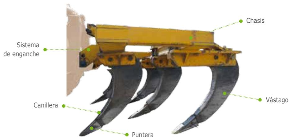
marco o una barra portaherramientas. Los marcos se utilizan con frecuencia en implementos roturadores que trabajan en socas porque las operaciones exigen una mejor distribución de los cuerpos en ambos sentidos: longitudinal y transversal.
