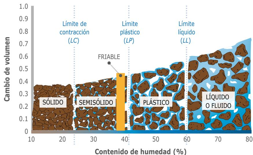
**Sólido.** El suelo se comporta como un sólido cuando presenta un contenido de humedad por debajo del límite de contracción (*LC*). En este punto cesa la variación de volumen de una masa de suelo en proceso de secado y el suelo presenta alta resistencia mecánica (cohesión).
