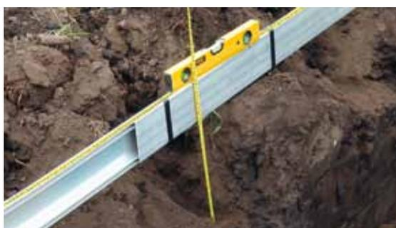
Para realizar las mediciones con el perfilómetro simplificado necesita un listón de 50 mm x 2 m, un nivel de gota y dos flexómetros.
