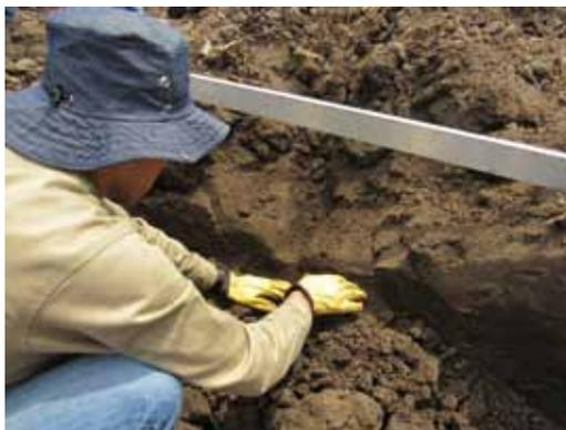
Los cuerpos presionan el suelo hasta vencer su resistencia pasiva, inician el proceso de roturación y fragmentación que responde a las características mecánicas del suelo, representadas principalmente en los coeficientes de cohesión (suelos arcillosos), fricción (suelos arenosos), cohesión y fricción (suelos francos). El perfil de la sección roturada puede despejarse para su respectiva evaluación.
