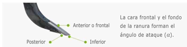
La succión se logra con un ángulo aproximado de  $10^\circ$  entre la cara posterior de la puntera y el fondo de la ranura; también, mediante el diseño de la puntera:
