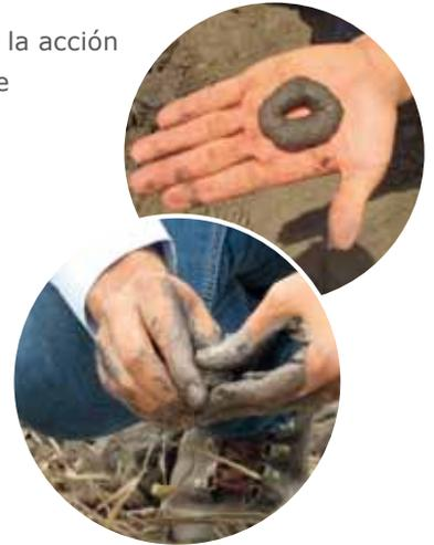
Un suelo en estado plástico cambia de forma con la presión, sin recuperación elástica (arriba). Se vuelve pegajoso y pierde capacidad de soportar esfuerzos cuando aumenta la humedad (abajo).
