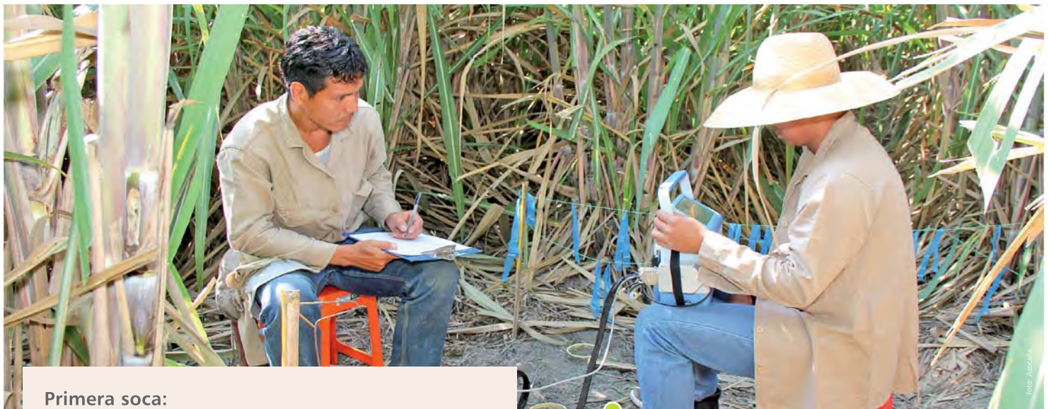
Medición de emisión de CO 2 desde el suelo con equipo IRGA.
