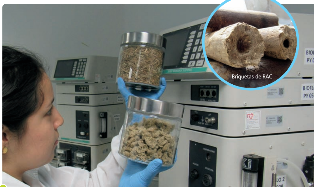
Cenicaña adelanta proyectos de investigación para producir bioetanol de segunda generación y briquetas a partir de los residuos agrícolas de cosecha.
