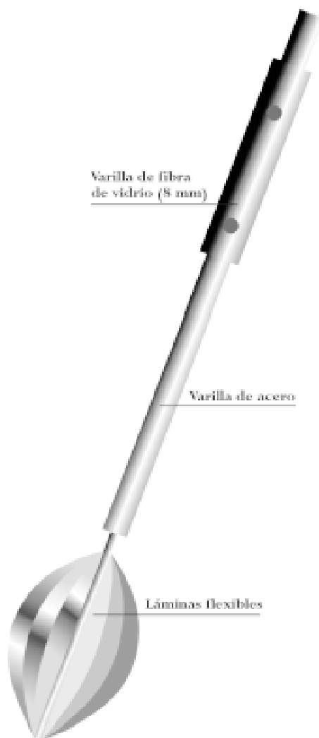
Figura 1. Verificador “Go”, utilizado para inspeccionar el alineamiento del dren y su estado interno luego de construido el sistema de drenaje (5).
