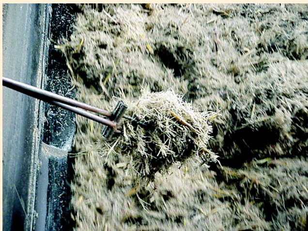
Toma de muestra en banda de alimentación de molino.
