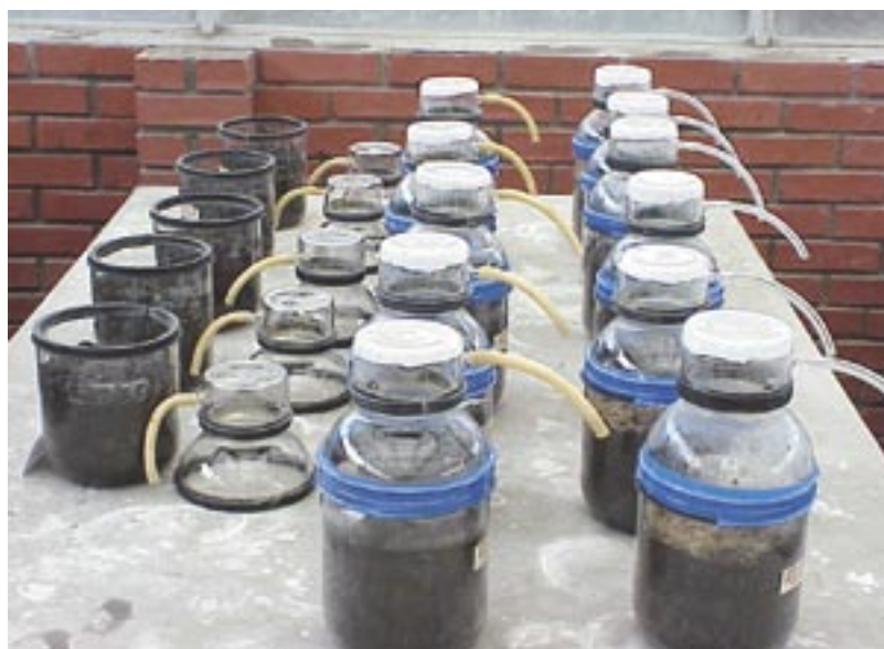
Figura 1. Colector de amoníaco análogo a un sistema de volatilización directa.
