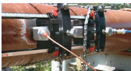
Mediciones de flujo con el equipo ultrasónico.
