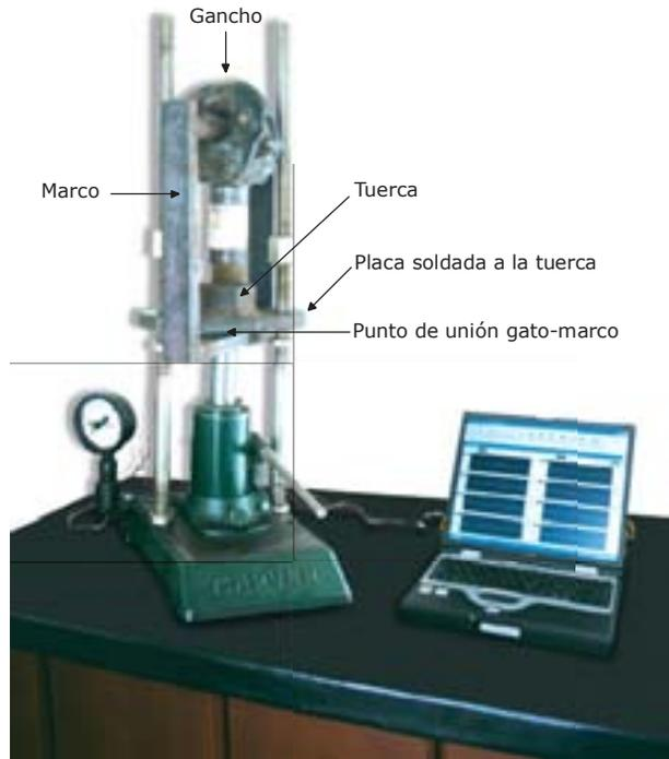
Figura 3. Montaje experimental utilizado para la calibración del gancho modificado.
