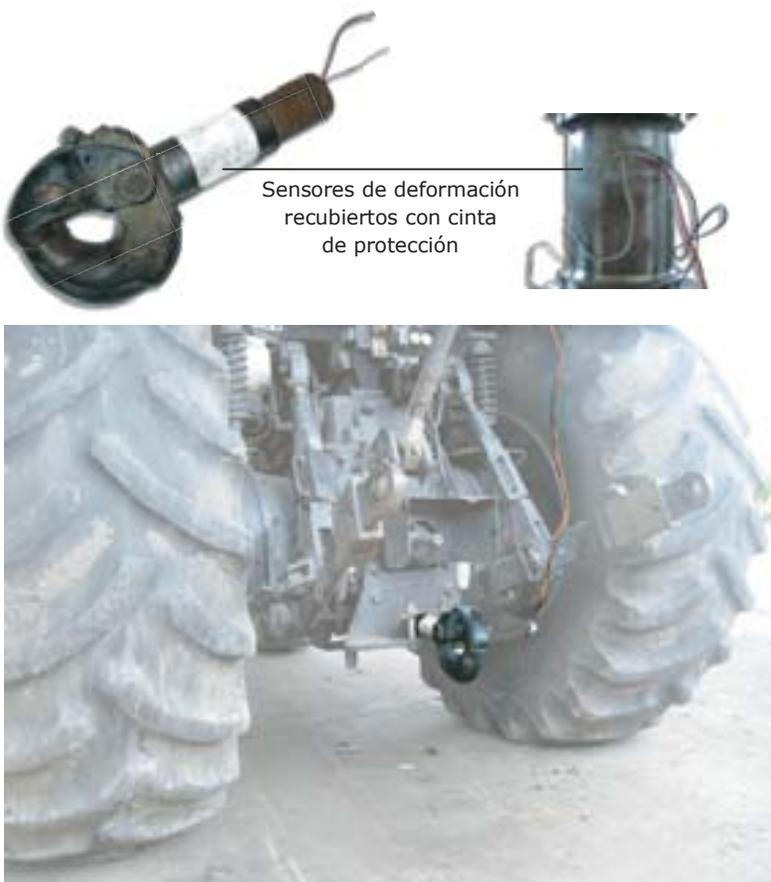
Figura 5. Montaje en tractor del gancho instrumentado como dinamómetro.
