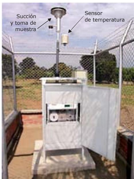
**Las estaciones de la Red PM10 poseen un muestreador de aire que utiliza el método de la atenuación radioactiva del Carbono-14 (emisión de rayos beta) para la medición automática, permanente y exacta de la concentración de material particulado con tamaño menor de 10 micrómetros en la atmósfera.**
