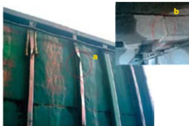
Figura 1. Fallas estructurales (a) Deformación de vigas laterales verticales; (b) Fractura transversal de viga horizontal en la base de la canasta.
