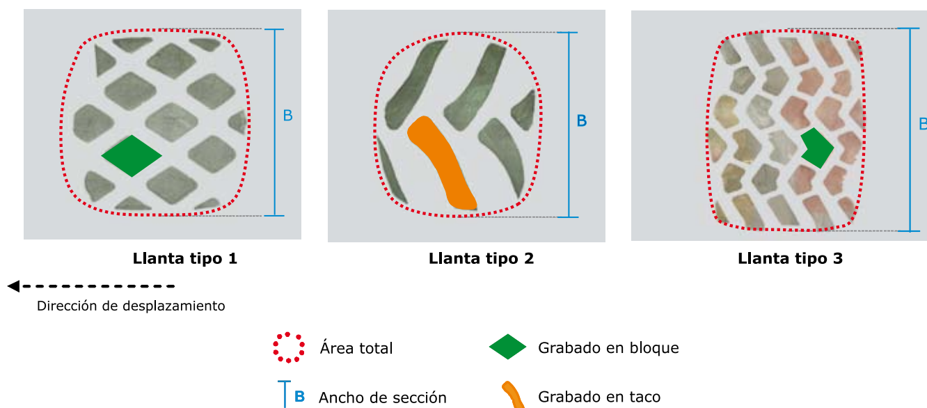
Figura 1. Huellas de contacto de tres tipos de llantas sobre una superficie plana (impresión en papel) usando un vagón cargado con caña picada.
