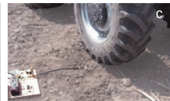
Figura 1. Instrumentación utilizada para la evaluación de la compactación de suelos: (a) Medición de resistencia a la penetración con penetrógrafo de cono, (b) Cenisensor y (c) Medición de esfuerzos.
