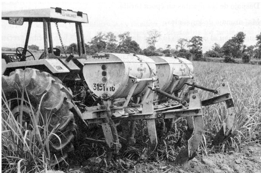
Figura 8. *Equipo integral para cultivo, fertilización y aporque de la caña de azúcar.*
