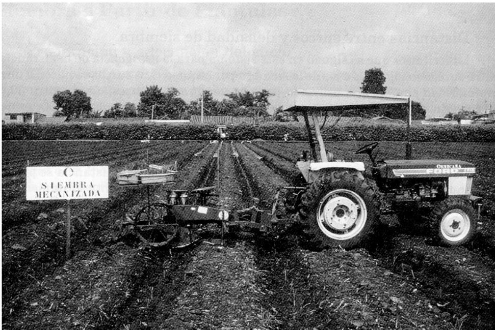
Figura 2. *Trasplante mecanizado de plántulas de caña de azúcar utilizando una máquina “Mechanical Transplanter Co.”, modelo 4000.*
