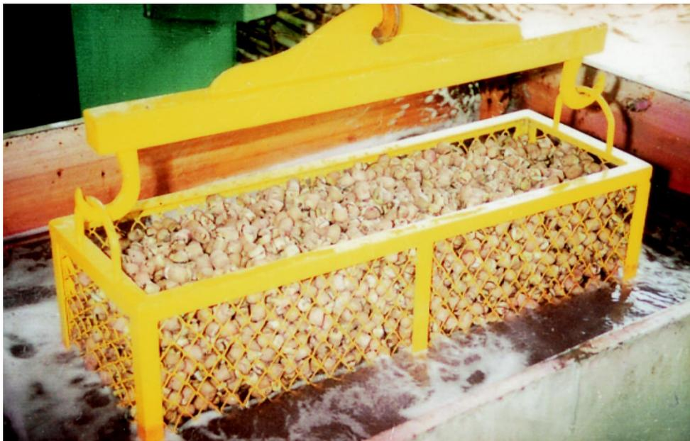
Figura 2. *Cámara para el tratamiento con agua caliente de la semilla de caña de azúcar.*
