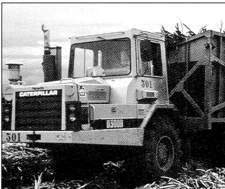
Figura 10. Tractor con tracción en los tres ejes y vagón robusto.
