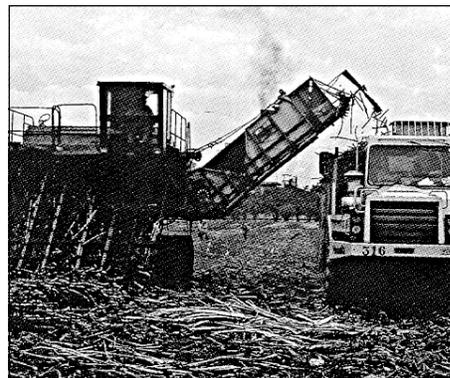
Figura 11. Alzadora continua de caña.
