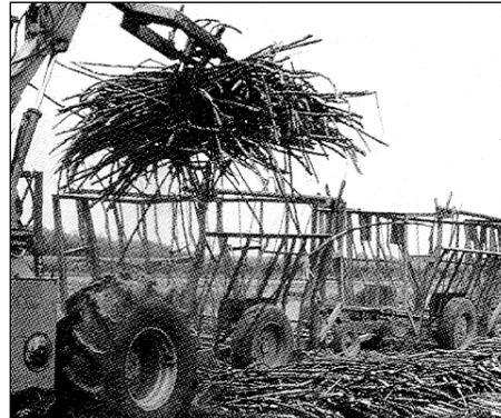
Figura 9. Alce mecánico por el sistema de "uña".
