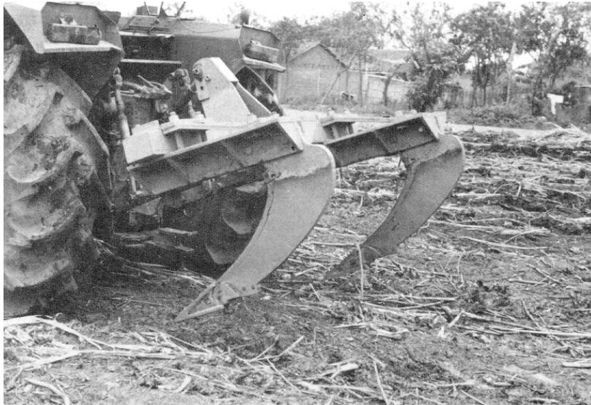
Figura 7. *Subsolador de brazos semiparabólicos.*
