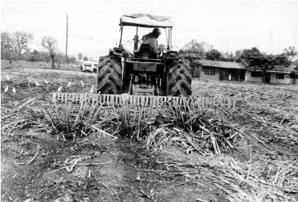
Figura 5. Encalladora tipo Toft para residuos poscosecha de la caña de azúcar.
