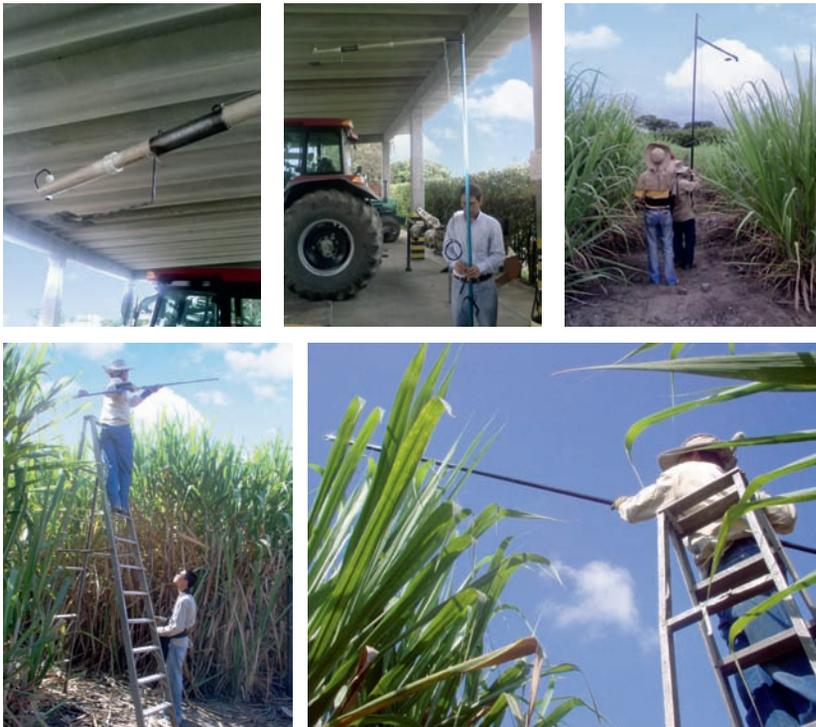
**Figura 37.** Construcción de la plataforma y su uso para la toma de lecturas de campo con el espectrorradiómetro. Cenicafía.
