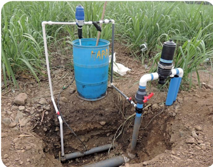
► **FIGURA 2.7.** Bomba de pistón para inyección de fertilizante: esquema y estación de campo.
