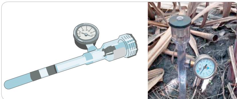
► FIGURA 3.15. Detalle de tensiómetro utilizado en suelos cultivados con caña de azúcar.
