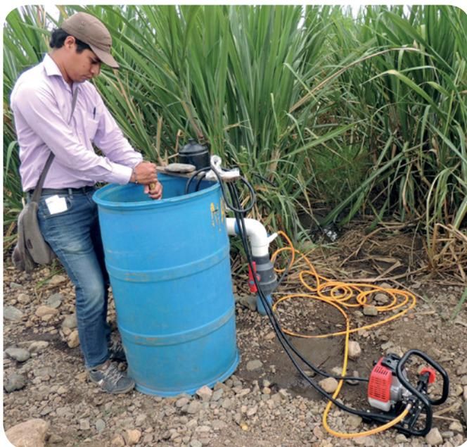
► FIGURA 2.8. Bomba de inyección en fertirriego: esquema y estación de campo.
