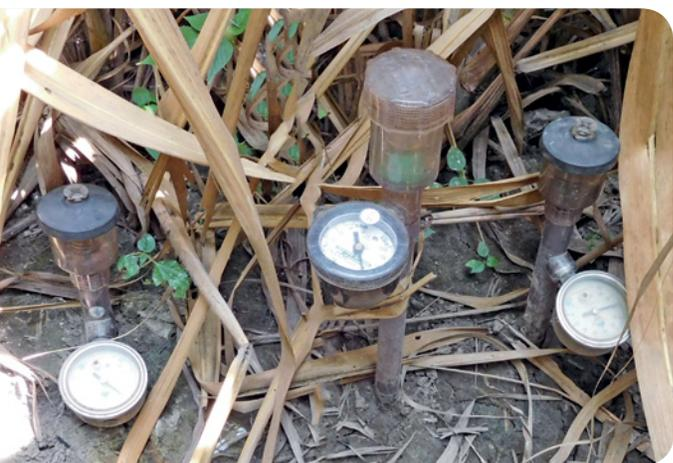
Batería de tensiómetros.
