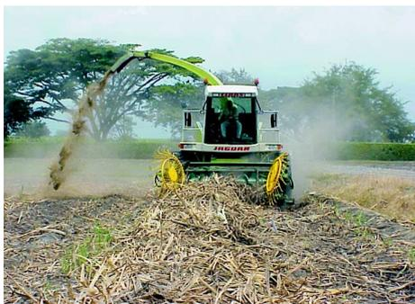
*Máquina picadora antes de instalar la nueva mesa alimentadora con capacidad para recoger en un solo pase los residuos provenientes de seis surcos de caña.*
