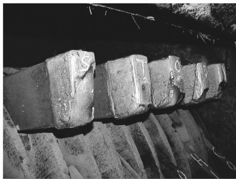
Martillos desgastados de una desfibradora de caña.
