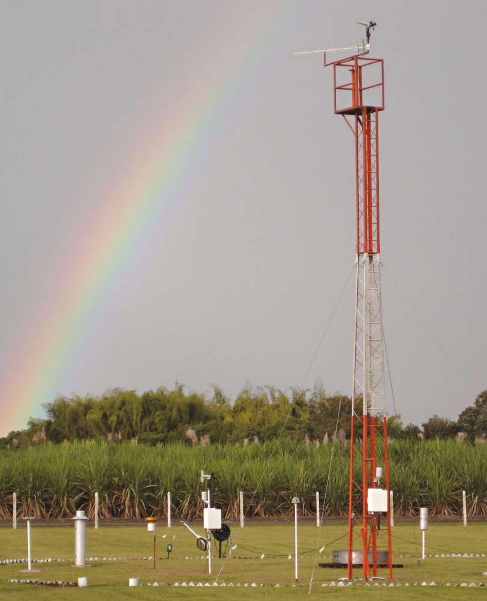
Estación meteorológica automatizada y estación convencional en la Estación Experimental de Cenicaña.
