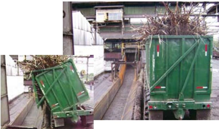
Figura 15. Vagón prototipo de concepto de descarga lateral.
