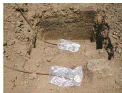
**Sensores instalados a diferentes profundidades.**
