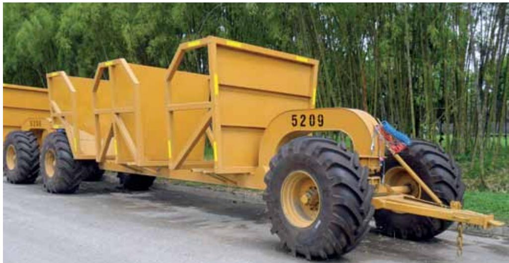
Los vagones disponibles se caracterizan por una tara de 4900 kg en promedio y capacidad volumétrica de 28 m<sup>3</sup>. La densidad de carga estimada se aproxima a 287 kg/m<sup>3</sup> (8200 kg de caña larga por vagón) y la relación teórica peso caña/peso acero se estima en 1.67.
