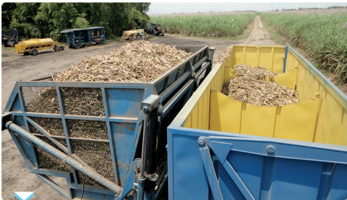
Transbordo de caña mecanizada a vagones de transporte DL 24000.
