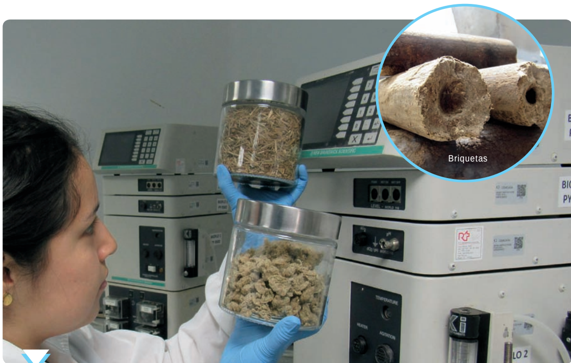
La obtención de celulosa a partir de residuos agrícolas de cosecha hace parte de los estudios que realiza Cenicaña en etanol de segunda generación. Briquetas de RAC elaboradas a escala experimental.
