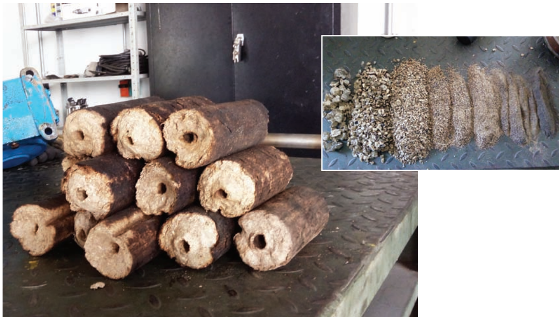
Figura 48. Briquetas de RAC y pruebas de trituración para su uso en combustión.
