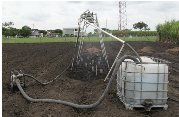
Vista general del simulador de lluvias construido.
