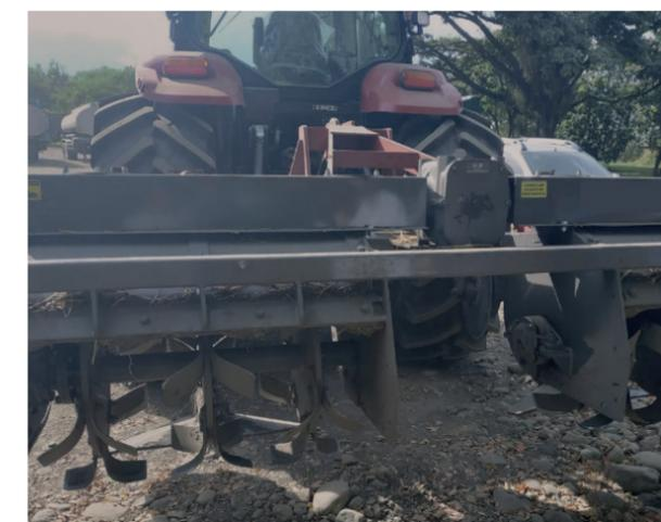
Fig. 41 Equipo para preparación de suelos tipo 'Rotavator'
