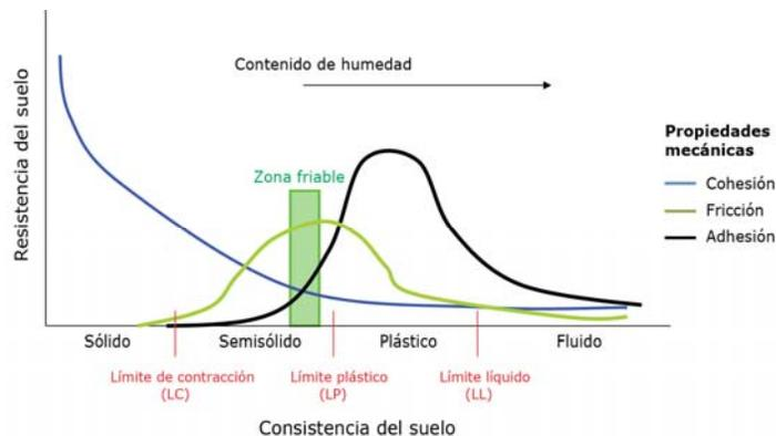
Figura 1. Efecto del contenido de humedad en las propiedades mecánicas del suelo y su consistencia.
