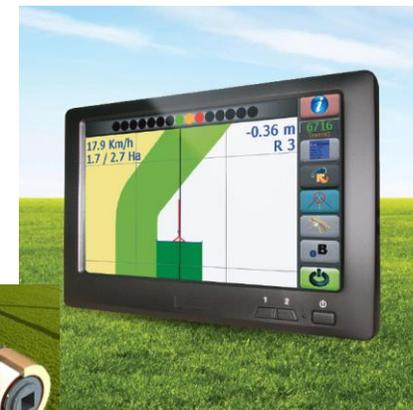
*Mediante la adaptación de sistemas comunes de fertilización granulada y la adaptación de válvulas de control y sensores, acompañados de Antenas de GPS se regula de forma precisa la cantidad de fertilizante aplicado, garantizando así que la dosis definida es la aplicada independiente de la velocidad del tractor*
