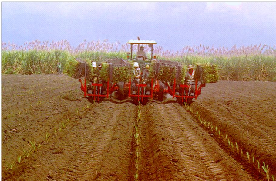
Figura 4. Trasplantadora de caña de azúcar modelo SC-96.
