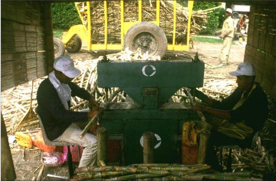
Figura 3. Máquina extractora de yemas provenientes de tallos de caña de azúcar.
