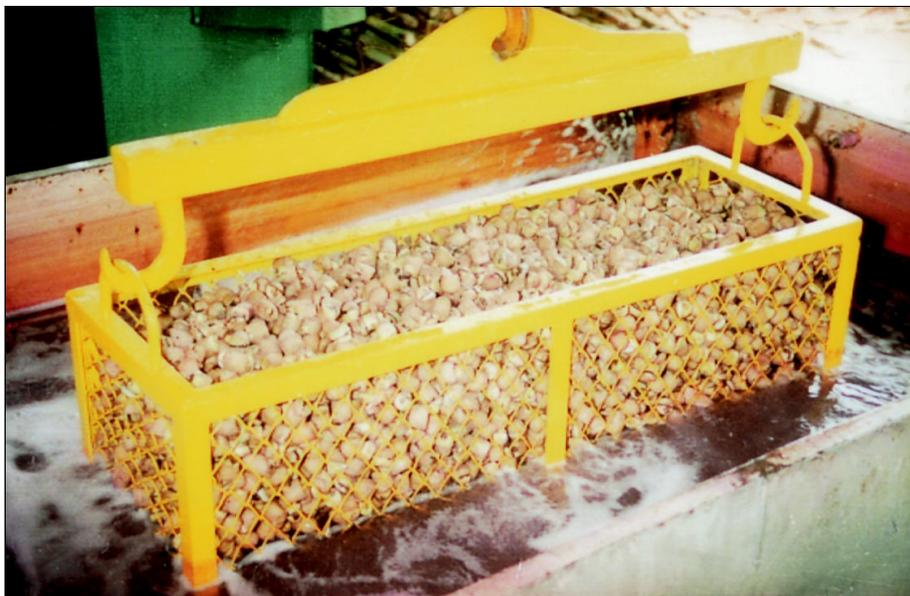
Figura 2. Cámara para el tratamiento con agua caliente de la semilla de caña de azúcar.
