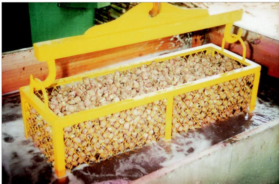
Figura 2. Cámara para el tratamiento con agua caliente de la semilla vegetativa de caña de azúcar.
