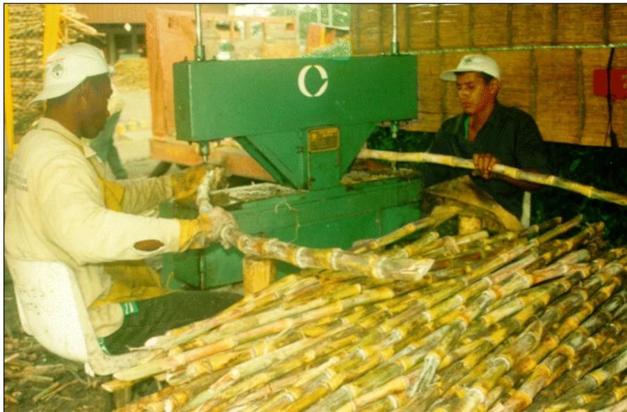
Figura 1. Máquina extractora de yemas de caña de azúcar.
