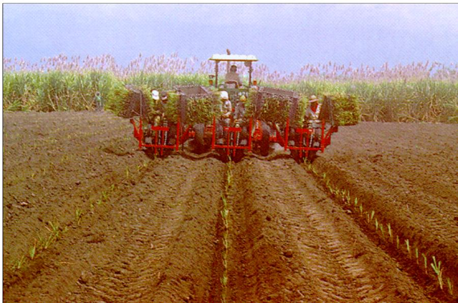
Figura 10. Trasplantadora de caña de azúcar, modelo SC-96.
