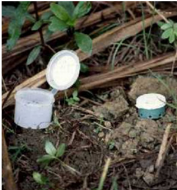
FIGURA 21. Trampa para la captura de obreras de hormiga loca, N. fulva . El recipiente más pequeño (derecha) se ceba con un trozo de salchicha y luego de 1 a 3 horas se recoge y se introduce en el recipiente mayor (izquierda) para su transporte y el conteo de los individuos (Foto L.A. Gómez).
