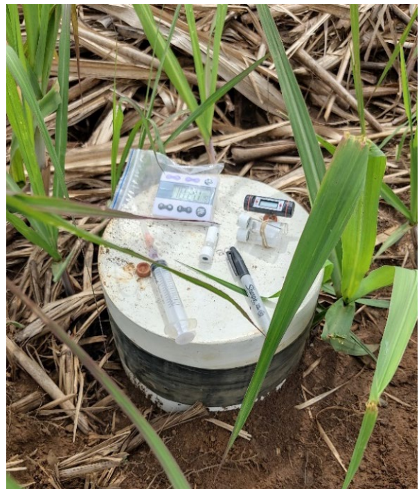
Medición de N 2 O en surco del cultivo de la caña de azúcar
