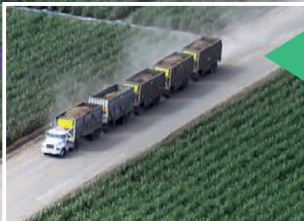
Transporte con tractomula y tren de vagones de descarga alta o descarga lateral.
