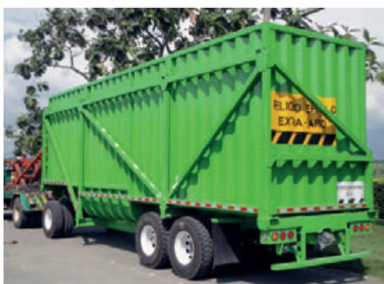
Figura 18. Vagón de transporte de mínimo peso tipo HD24000.
